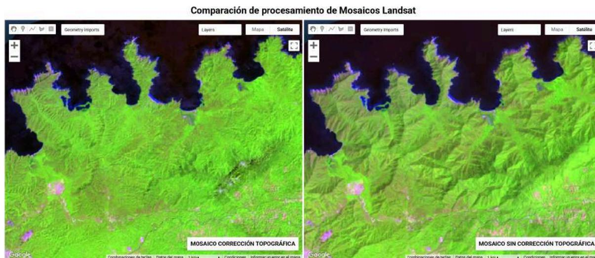
**Figura 24** Ejemplo de corrección topográfica Parque Nacional Natural Tayrona. Imagen izquierda: Mosaico con corrección topográfica. Imagen derecha; Mosaico sin corrección topográfica.
